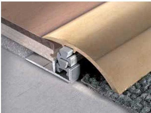
Profil d'arrêt pour raccorder les différences de niveau entre 12÷18 mm et plus. Utilisable avec au moins deux clips de fixation, ce profil permet de raccorder aisément un sol en carrelage ou parquet à des surfaces d'origine, mais aussi à des revêtements minces: la moquette ou le vinyle. Grâce à la forme particulière des clips en nylon et à leur rainure à la base, ils admettent au profil quelques millimètres de jeu latéral.
